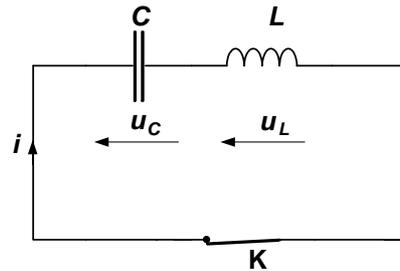
2.5.2. La solution de cette équation différentielle peut s'écrire  $u_C(t) = U_0 \cos\left(\frac{2\pi}{T_0} t\right)$ .
