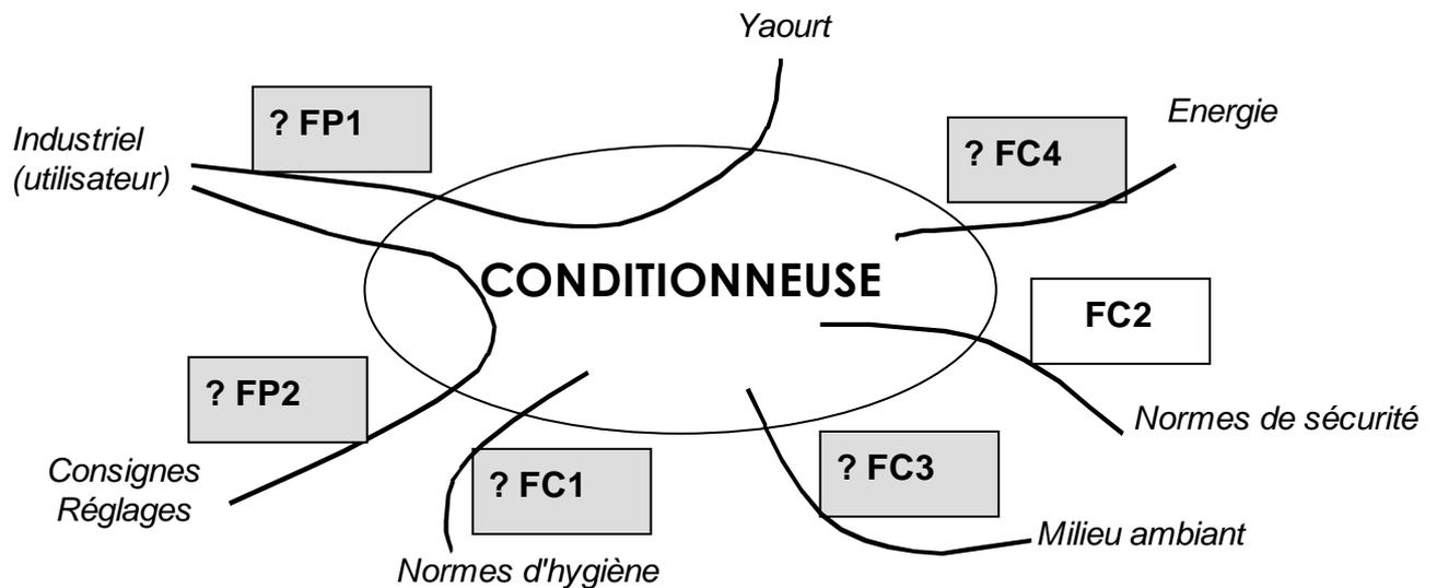
**FP1** ⇒ Permettre à l'industriel de conditionner automatiquement du yaourt en pots**FP2** ⇒ Permettre à l'utilisateur de gérer les consignes et d'effectuer des réglages**FC1** ⇒ Respecter les normes d'hygiène**FC2** ⇒ ? Respecter les normes de sécurité**FC3** ⇒ Résister au milieu ambiant**FC4** ⇒ S'adapter à l'énergie**A2- Solutions constructives****Question N°2**
