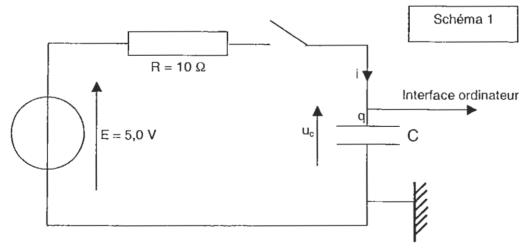
L'ensemble RC est attaqué par un générateur de tension  $E=5,0\ V.$  Le sens positif du courant et les tensions sont indiqués sur le schéma.
