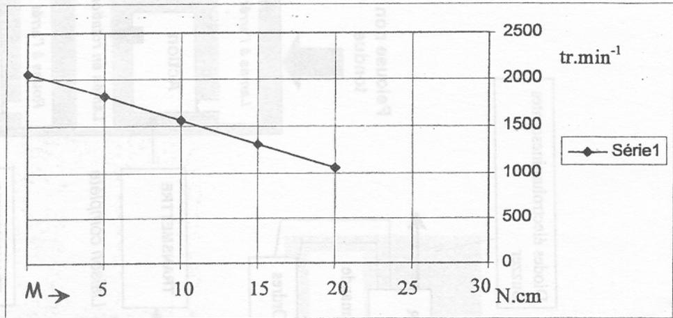
Fréquence de rotation minimum du moteur de coupe :
