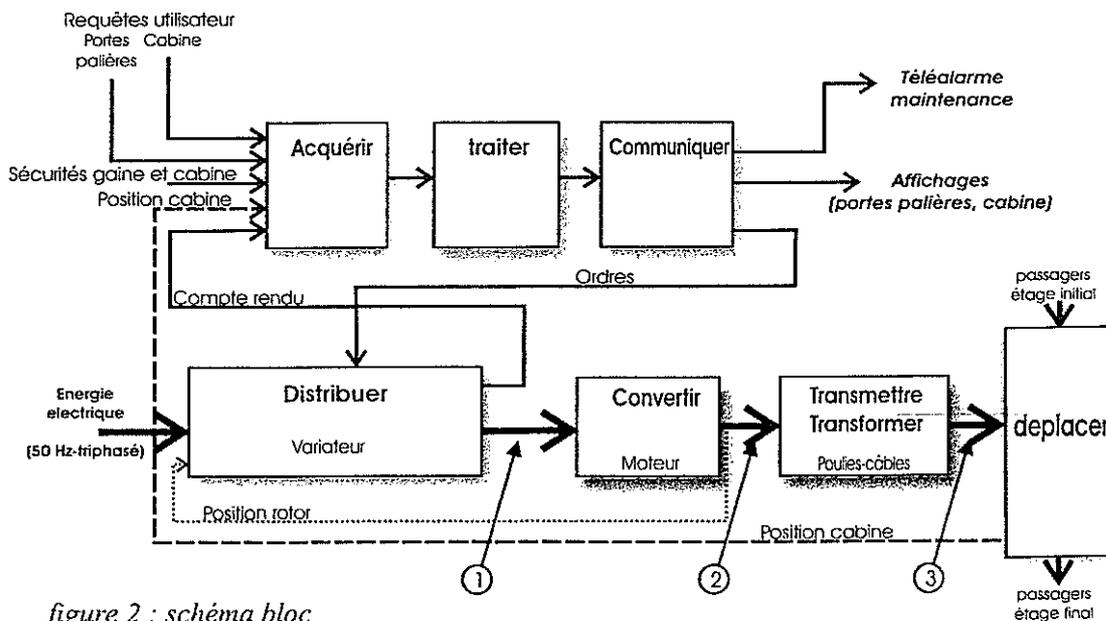
figure 2 : schéma bloc
