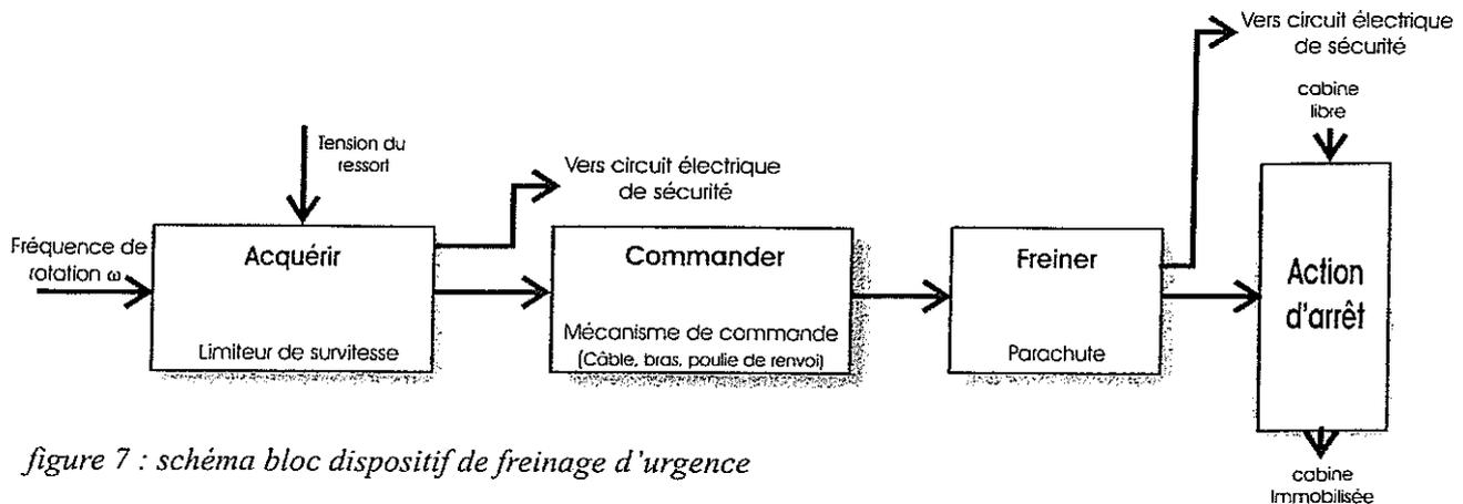
figure 7 : schéma bloc dispositif de freinage d'urgence
