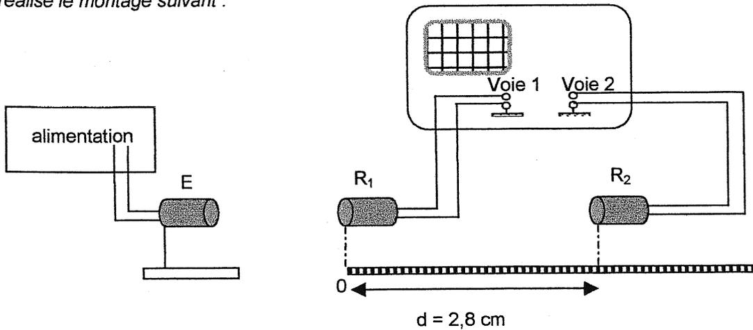
L'émetteur  $E$  génère une onde ultrasonore progressive sinusoïdale qui se propage dans l'air jusqu'aux récepteurs  $R_1$  et  $R_2$ . L'émetteur et les deux récepteurs sont alignés.
