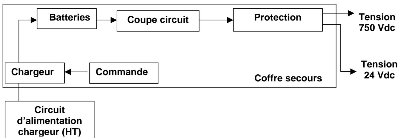
Le « coffre secours » est capable de fournir deux tensions pour les deux circuits équipant une rame tramway :
