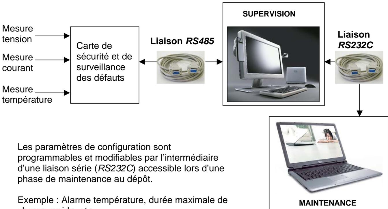
Les paramètres de configuration sont programmables et modifiables par l'intermédiaire d'une liaison série (RS232C) accessible lors d'une phase de maintenance au dépôt.
