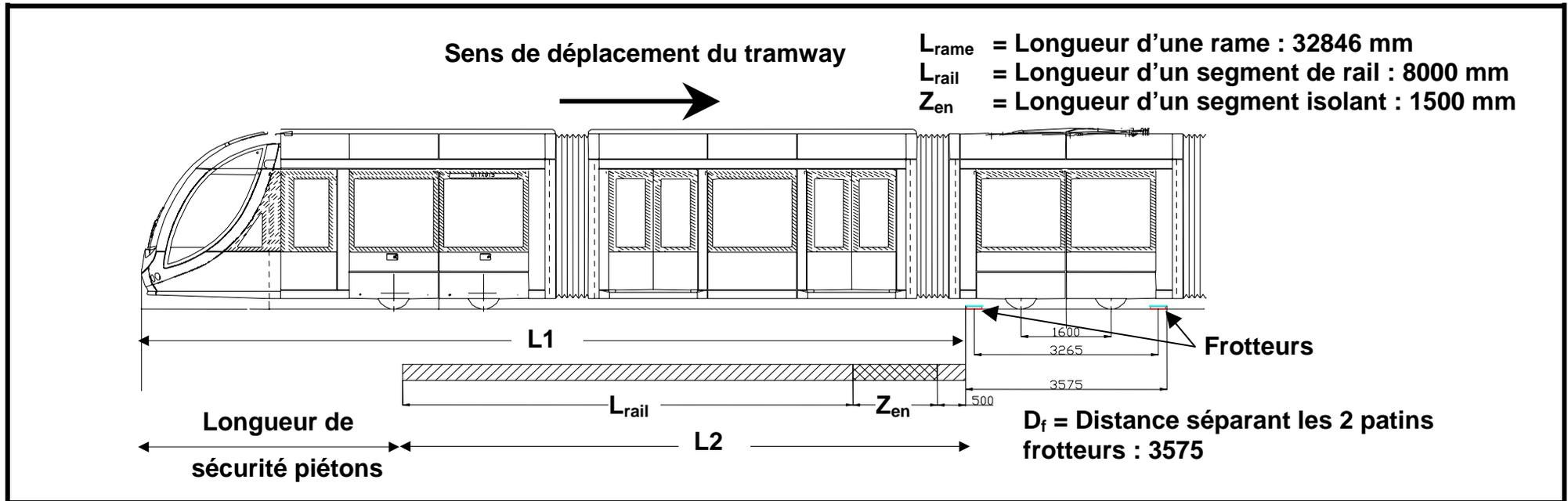
Sur le tramway, la distance entre le dernier frotteur et l'extrémité du tramway est donnée par :
