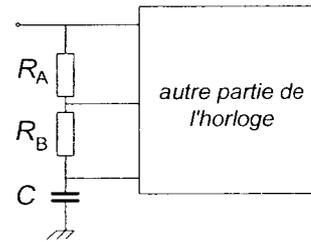
Dans un premier temps le condensateur, initialement déchargé, de capacité  $C$  est chargé à travers les conducteurs ohmiques de résistances  $R_A$  et  $R_B$ . On note  $E$  la tension aux bornes du générateur. Lors de cette étape, on considère que les conducteurs ohmiques et le condensateur de capacité  $C = 22 \mu\text{F}$  sont branchés en série. Le circuit équivaut alors à celui qui est schématisé figure 3 avec  $R = R_A + R_B = 66 \text{ k}\Omega$ .
