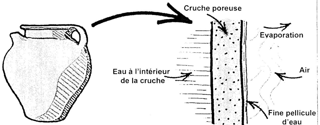
La réfrigération par évaporation est une technologie de réfrigération connue depuis des millénaires : les cruches poreuses et les outres en peau rafraîchissent leur contenu par l'évaporation d'eau à leur surface.
