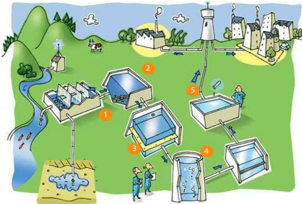
① L'eau passe à travers une simple grille, afin d'arrêter les plus gros déchets présents dans l'eau (feuilles, insectes, particules de plus de 1 mm).
