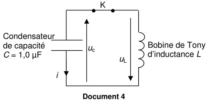
Tony se souvient que la tension  $u_c(t)$  aux bornes du condensateur oscille au cours du temps. Si la résistance totale du circuit est négligeable, l'équation différentielle qui régit l'évolution de la tension  $u_c(t)$  est :
