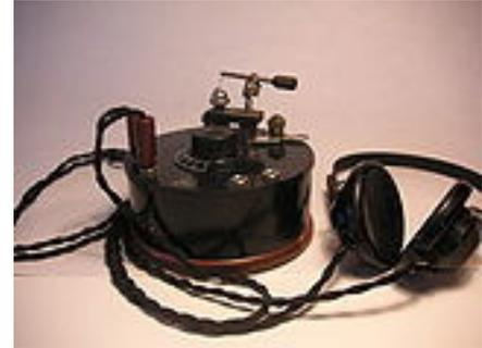
Dès 1911, à l'aide d'un émetteur à arc et d'un poste à galène, les stations côtières effectuaient des liaisons radiotélégraphiques avec les navires. La fréquence  $F = 500$  kHz était la fréquence internationale de détresse. C'est sur cette fréquence que Jack Philips envoya le premier SOS lors du naufrage du Titanic le 15 avril 1912.
