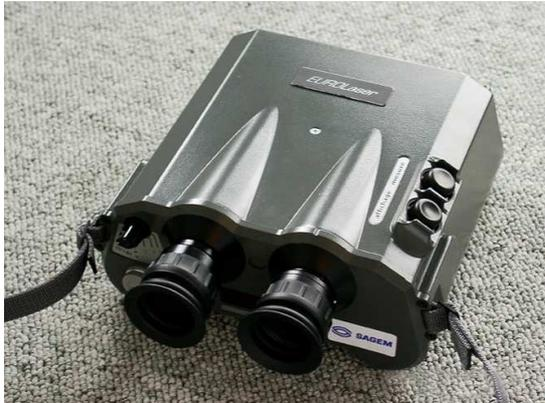
*Un cinémomètre permet la détermination de la vitesse d'un véhicule. Les distances successives séparant le véhicule de l'appareil sont obtenues par la mesure du temps mis par une impulsion laser pour atteindre la cible visée et revenir au cinémomètre après réflexion.*
