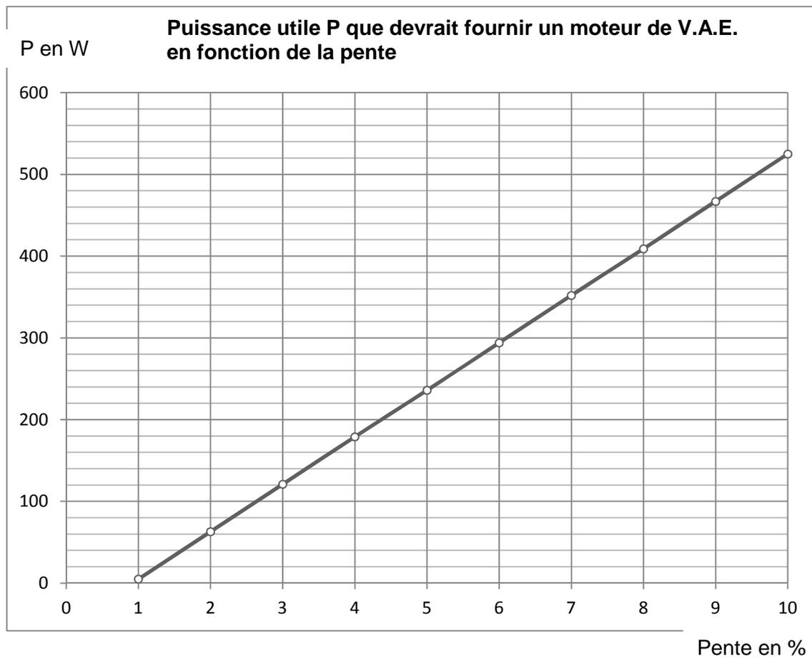
Le graphique ci-dessus représente la puissance que devrait apporter le moteur électrique en fonction de la pente (exprimée en %) pour maintenir une vitesse constante de  $15 \text{ km.h}^{-1}$  lorsque la puissance de Maurice est de 60 W.
