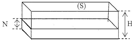
Pour simplifier la démarche, on considère que le réservoir est de section de surface  $S = 0,2 \text{ m}^2$  et de hauteur  $H$ . Le niveau de carburant dans le réservoir est noté  $N$ .
