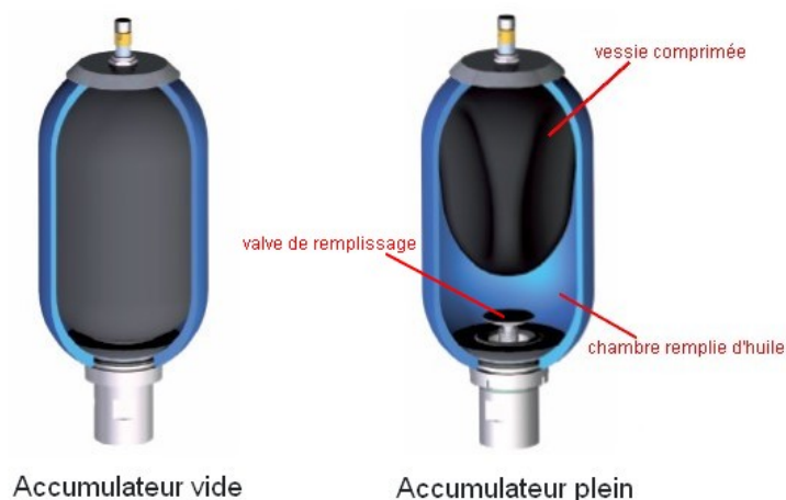
Figure 10 : états de fonctionnement d'un accumulateur hydraulique
