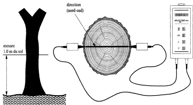
Principe de mesure de dégradation du bois d'un tronc par méthode non destructive
