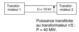
Les câbles, utilisés pour AmpaCity, sont conçus pour permettre le transfert d'une puissance de valeur 40 MW sous une tension de valeur 10 000 V. Grâce aux caractéristiques du matériau supraconducteur, une céramique particulière, et à son refroidissement à de très basses températures, le câble est un conducteur électrique idéal. À Essen, le câble supraconducteur remplace une ligne à haute tension traditionnelle utilisant un câble traditionnel de même diamètre!
