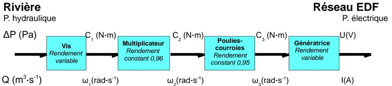
**Q10.** À partir des rendements des différents éléments de la chaîne de transmission de puissance indiqués figure 6, **déterminer** le rendement global et **évaluer** la puissance électrique que l'on peut attendre de l'installation.
