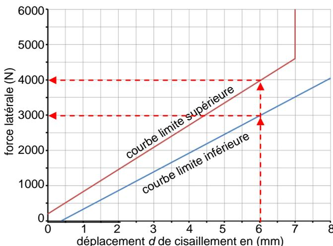
Pour un déplacement de 6 mm, l'effort maximal est de 4 000 N et le minimal de 3 000 N.
