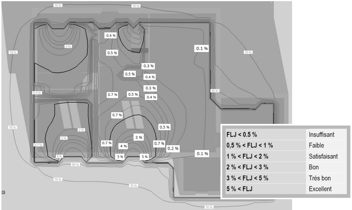
Figure n°2 : Carte de Facteur de Lumière du jour avec deux conduits de lumière
