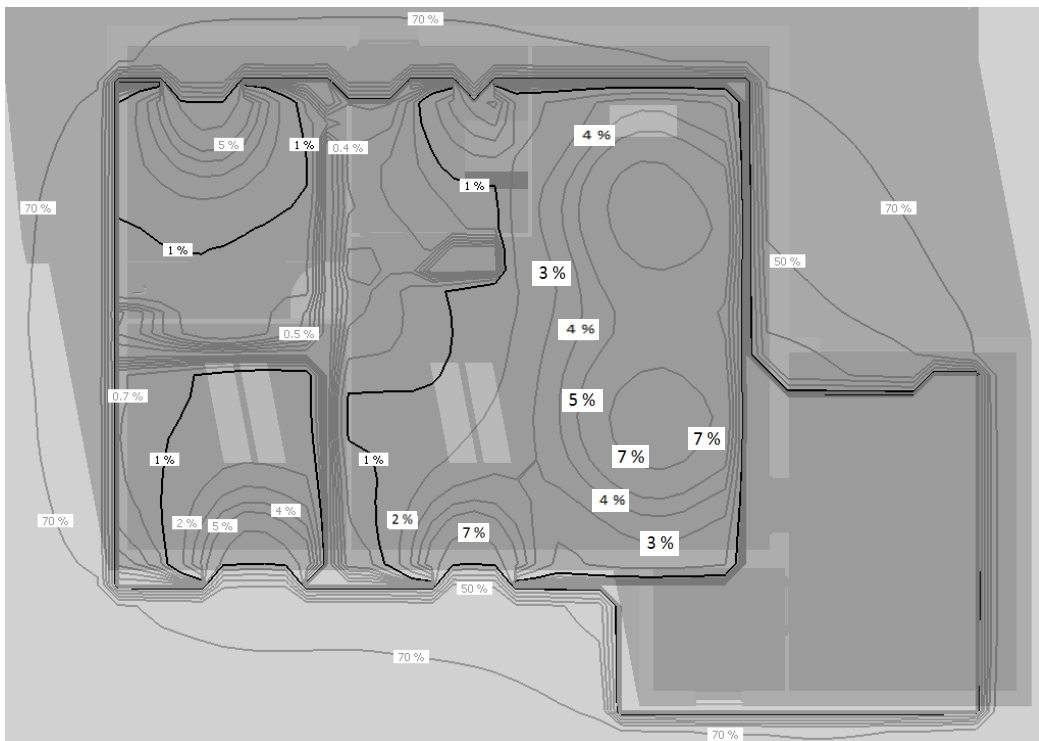
Figure n°2 : Carte de Facteur de Lumière du jour avec deux conduits de lumière
