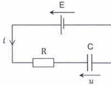
On note  $u$  la tension exprimée en volt aux bornes du condensateur. Cette tension  $u$  est une fonction du temps  $t$  exprimé en seconde.
