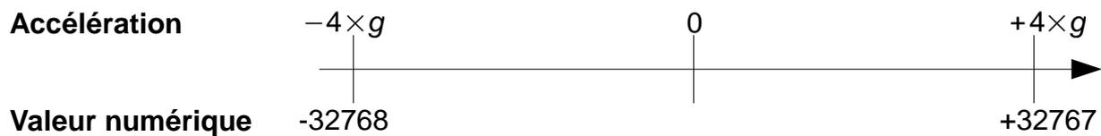
Figure 13 : correspondance entre les accélérations mesurées et les nombres envoyés par l'accéléromètre avec  $g \approx 9,81 \text{ m}\cdot\text{s}^{-2}$
