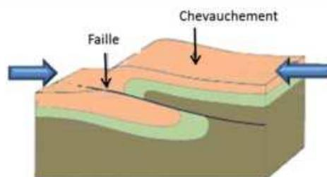
Ainsi, plis, failles inverse et nappes de charriage sont des **indices tectoniques** d'un raccourcissement associé à un épaissement de la croûte dans les chaînes de montagne, qui témoignent des contraintes convergentes lors de la collision. Les empilements en profondeur sont à l'origine des reliefs en surface et de la racine crustale en profondeur.
