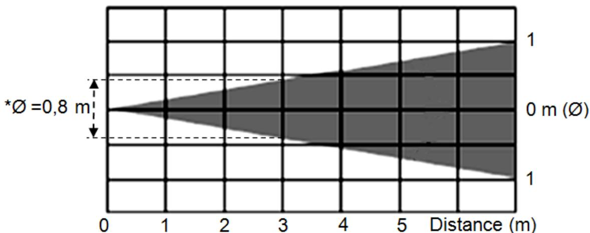
\*Exemple : L'éclairage d'un projecteur placé à 3 mètres et émettant une lumière bleue est de 190 Lux sur un diamètre de 0,8 mètre.
