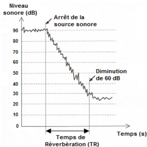
La durée de réverbération TR est le temps nécessaire pour que le niveau de bruit diminue de 60 dB (décibel) après l'arrêt de la source sonore en fonctionnement.
