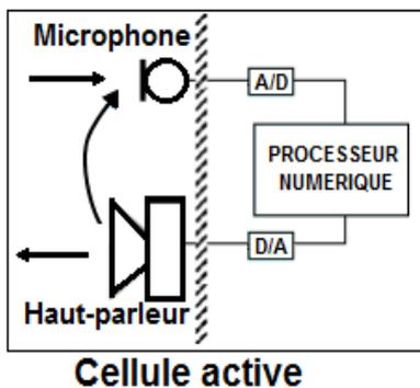
Chaque cellule active comporte un microphone, un traitement numérique des signaux réalisé avec des processeurs DSP (Digital Signal Processing) et un haut-parleur.
