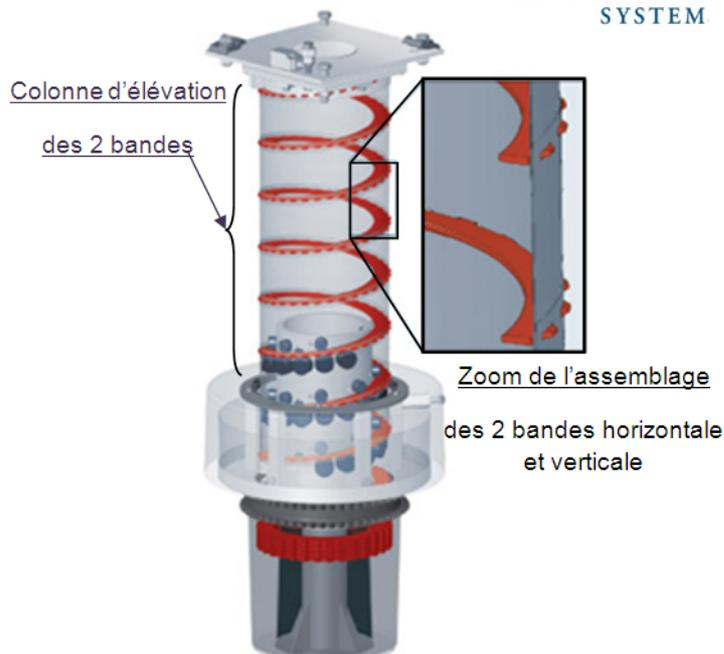
La colonne en acier inoxydable du I-Lock Spiralift est formée par un mouvement de rotation qui connecte deux ensembles de bandes métalliques ensemble.
