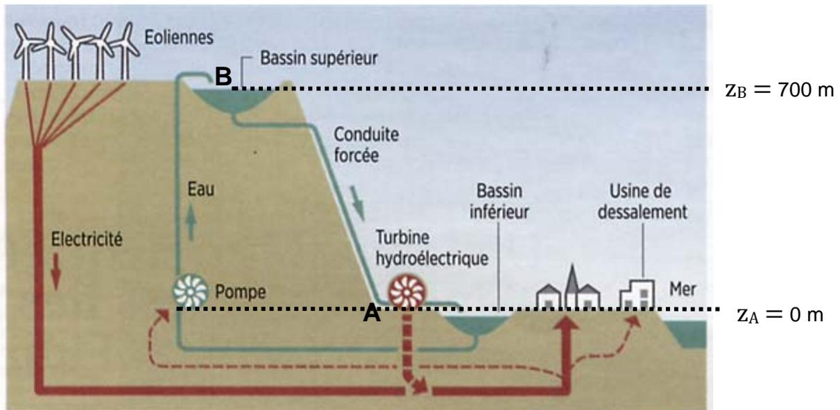
**A.2.4** Sachant que le rendement d'une centrale hydroélectrique est de 90,0 % et en supposant les pertes de charges nulles, démontrer que l'énergie électrique produite,  $E_{elec}$ , lorsque le bassin supérieur se vide entièrement, vaut  $3,40 \times 10^{12}\text{ J}$ .
