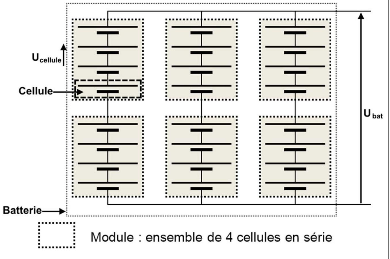
La tension aux bornes de la batterie,  $U_{\text{bat}}$ , vaut 355 V.
