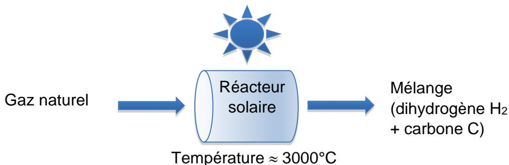
Il faut ensuite séparer le dihydrogène des particules de carbone.
