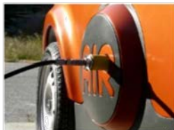
Recharge sur réseau d'air comprimé
