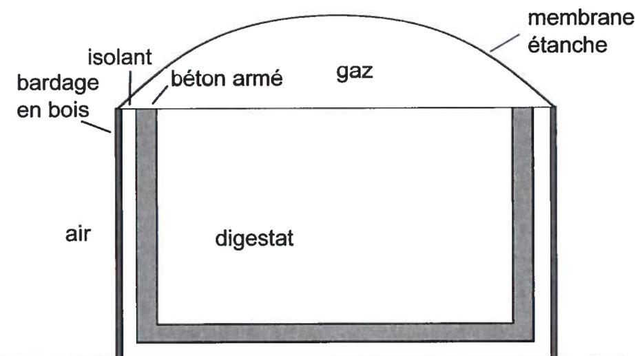
Le méthaniseur est assimilable à un cylindre en béton armé, d'épaisseur  $e_1 = 30$  cm, d'un diamètre  $D = 10,0$  m et d'une hauteur  $h = 5,0$  m. Il est isolé par l'extérieur avec du polystyrène d'épaisseur  $e_2 = 15$  cm. Un bardage en bois d'épaisseur  $e_3 = 2,0$  cm protège le dispositif des intempéries. La poche de biogaz au sommet de l'ensemble est retenue par une membrane étanche, comme le montre le schéma ci-dessus.
