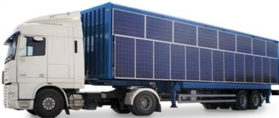
L'ensemble du système peut être installé sur une remorque capable de se déplacer très rapidement afin de satisfaire la demande en énergie électrique de façon immédiate. Il s'agit d'une alternative durable aux groupes électrogènes thermiques classiques, en fournissant d'importantes économies en combustible fossile avec des émissions de dioxyde de carbone moindres.
