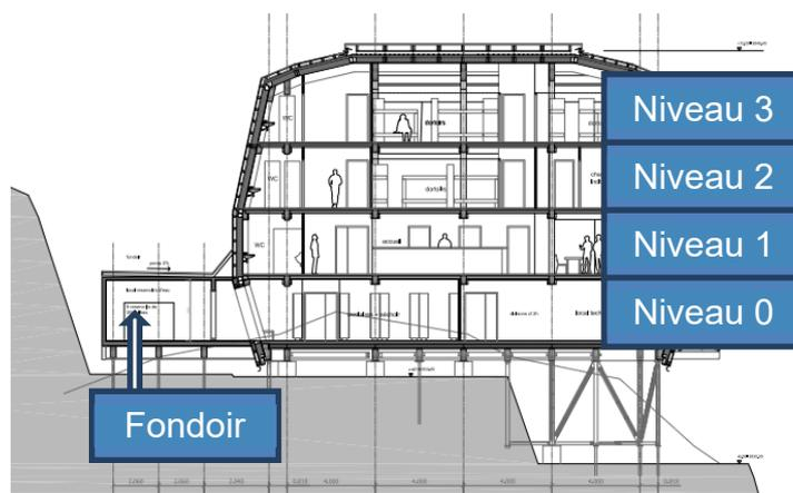
La structure est en bois local. L'enveloppe extérieure métallique est composée de pièces en inox conçues pour résister à des vents moyens de  $240 \text{ km}\cdot\text{h}^{-1}$  et aux écarts thermiques.
