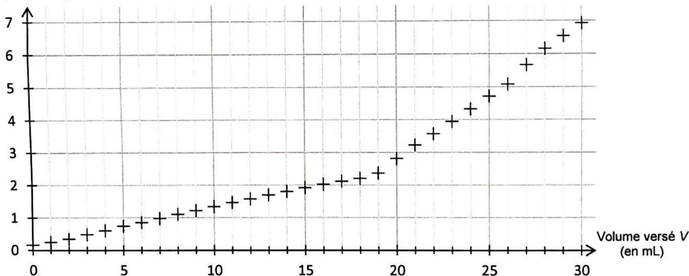
Figure 2. Évolution de la conductivité  $\sigma$  en fonction du volume  $V$  de la solution titrante versée
