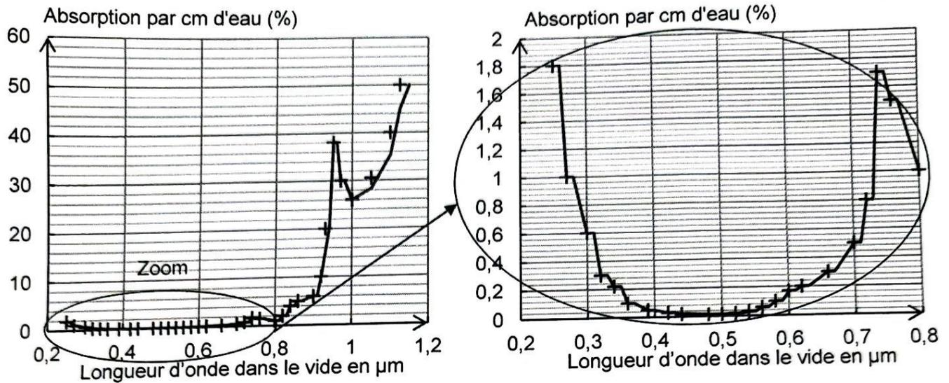
Figure 5. Absorption par cm d'eau en fonction de la longueur d'onde dans le vide
