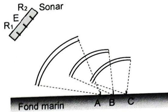
Figure 4. Propagation des échos vers le sonar
