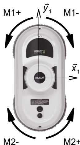
Figure 7 : définition du sens de rotation des moteurs
