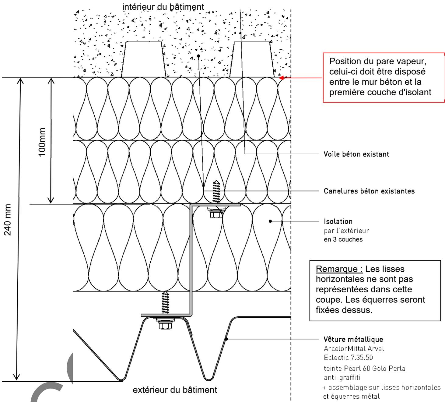
**Rôle du pare vapeur :** Il faut éviter la condensation de l'air dans l'isolant sinon ses caractéristiques d'isolation s'amointrissent. Ainsi, les couches isolantes seront pourvues d'un pare vapeur qui se placera du côté de la face la plus chaude de l'isolant.
