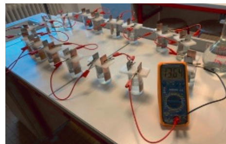
Figure 3. Photographie du montage exp rimental reconstituant la superposition de 16 cellules  l mentaires
