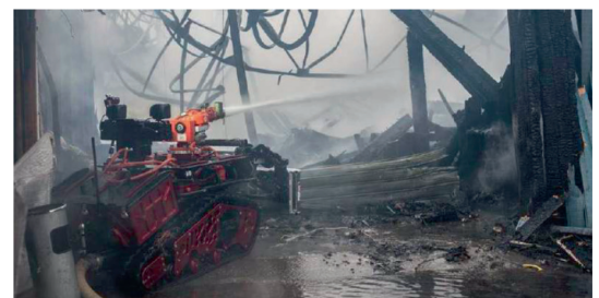
Figure 7 : Colossus version canon à eau + tourelle vidéo
