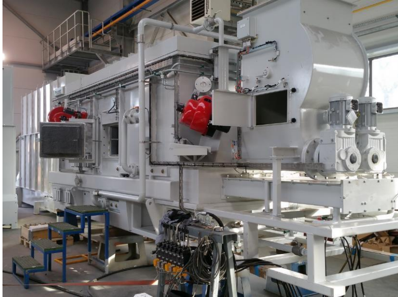
Unité de valorisation énergétique des déchets plastiques
