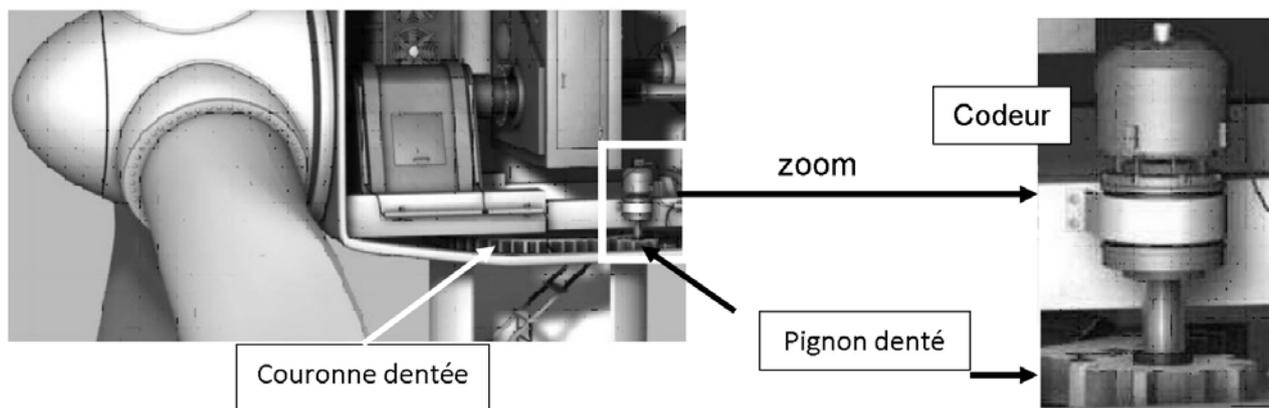
Les données du codeur sont envoyées à l'unité de traitement par un bus de communication SSI.
