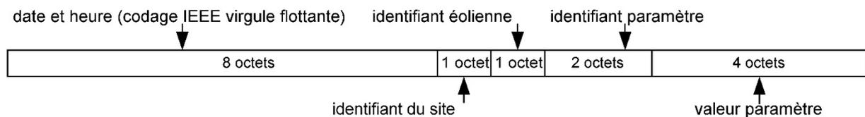
Question D.1 | **Calculer** la taille du fichier de stockage de l'ensemble des paramètres d'une éolienne. **Exprimer** le résultat en kilo-octet (1 ko = 1024 octets).
