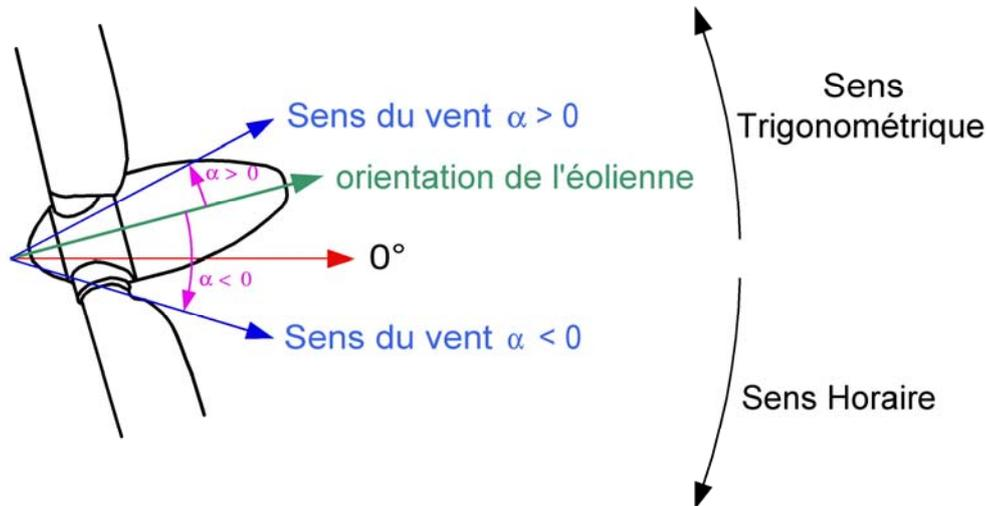
Question C.2 | À l'aide de la vue de dessus de l'éolienne donnée ci-dessus, **compléter** l'algorithme de rotation de la nacelle en plaçant les différents textes suivants :
