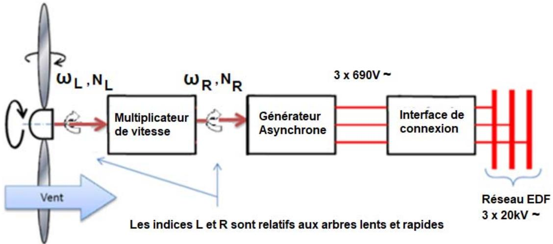
**synoptique de la structure de production de l'énergie électrique**
