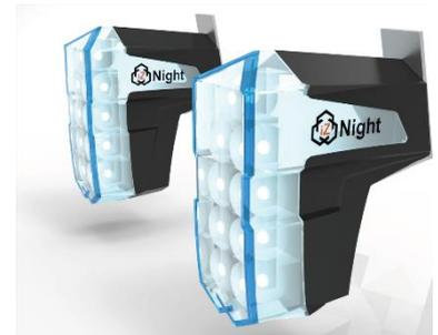
La société GiroNac a développé un phare accessoire (kit iZ-Night) qui s'installe en complément du phare d'origine sur la moto. Il peut suivre les yeux du pilote pour bien éclairer la sortie du virage, grâce à une matrice comprenant plusieurs LED. Il est, en fait, asservi à un capteur situé derrière le casque et qui capte les mouvements de la tête. Sous la selle se trouve en plus un autre capteur qui analyse la trajectoire de la moto.
