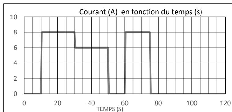
Figure 1-1 : évolution du courant moteur en fonction du temps
