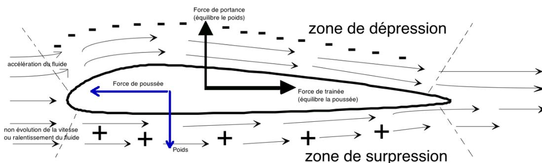
Figure 3 : coupe d'un hydrofoil
